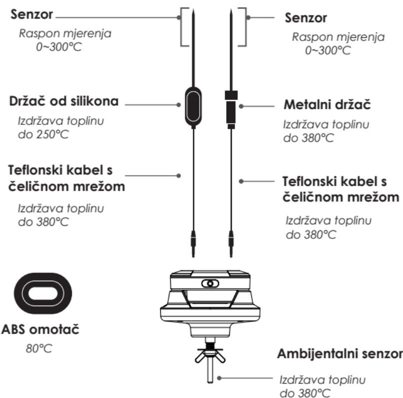
**Pozor: Temperature sondi iznad su samo za referencu, podložne su stvarnim sondama.**
